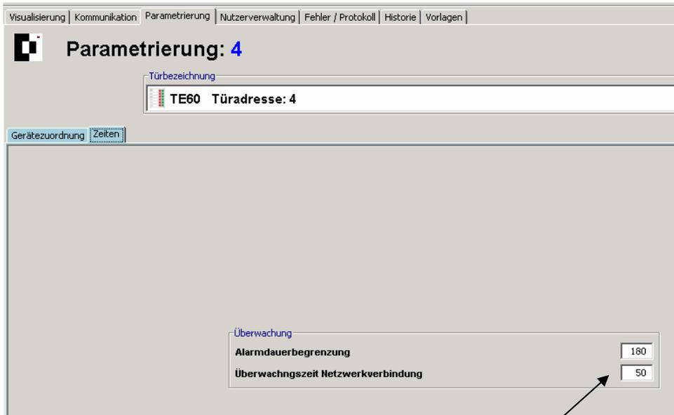
Statusmeldungen zyklisch senden (Sekunden). Die Zeit muss mit der Überwachungszeit Netzwerkverbindung abgestimmt werden.
