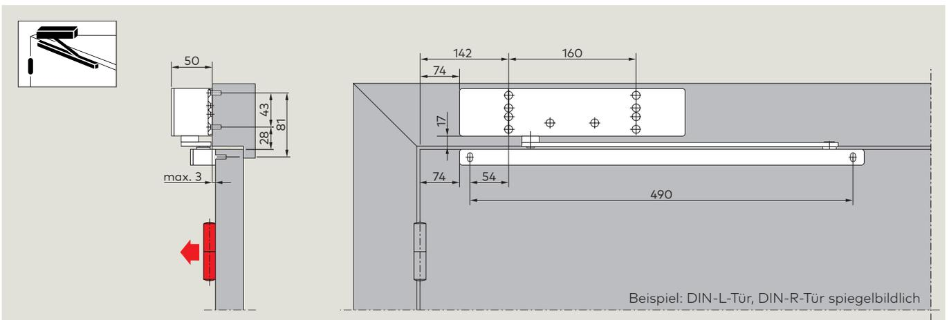
Unter entsprechenden baulichen Voraussetzungen ist bei dieser Montageart ein Öffnungswinkel von 180° möglich.
