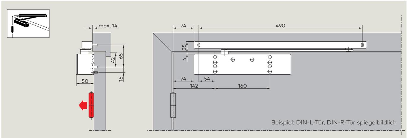
Unter entsprechenden baulichen Voraussetzungen ist bei dieser Montageart ein Öffnungswinkel von 180° möglich. In den meisten Fällen ist dafür eine Wandausnehmung für den Türschließer vorzusehen.
