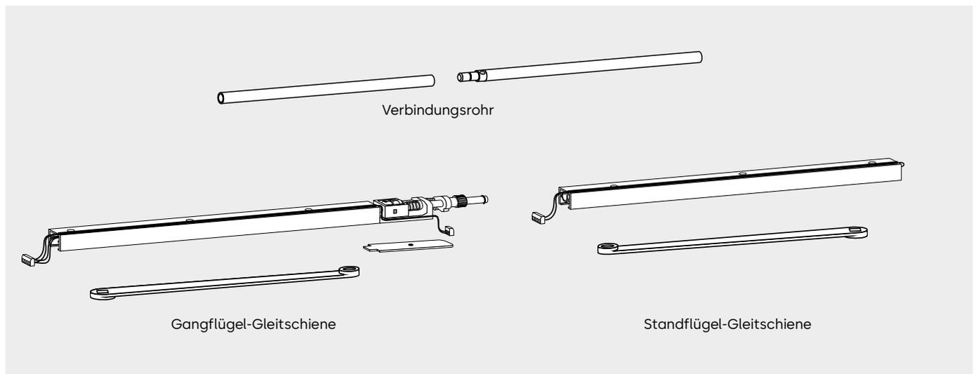
Ein Gleitschienen-Schließfolgeregler G 96 GSR-EMF umfasst eine Gang- und Standflügel-Gleitschiene mit elektromechanischer Feststellung, ein Verbindungsrohr, eine Abdeckung für den Lagerbock der Gangflügel-Gleitschiene und zwei Hebel.
