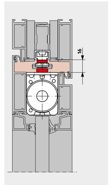
Holz­tür mit Block­zarge, doppelt über­fälzt, Falz­raum 20 mm, mit ITS 96/ITS 96 FL EN 3–6 mit 8 mm ver­längerter Achse und Gleit­schiene G 96 N20 K12.
