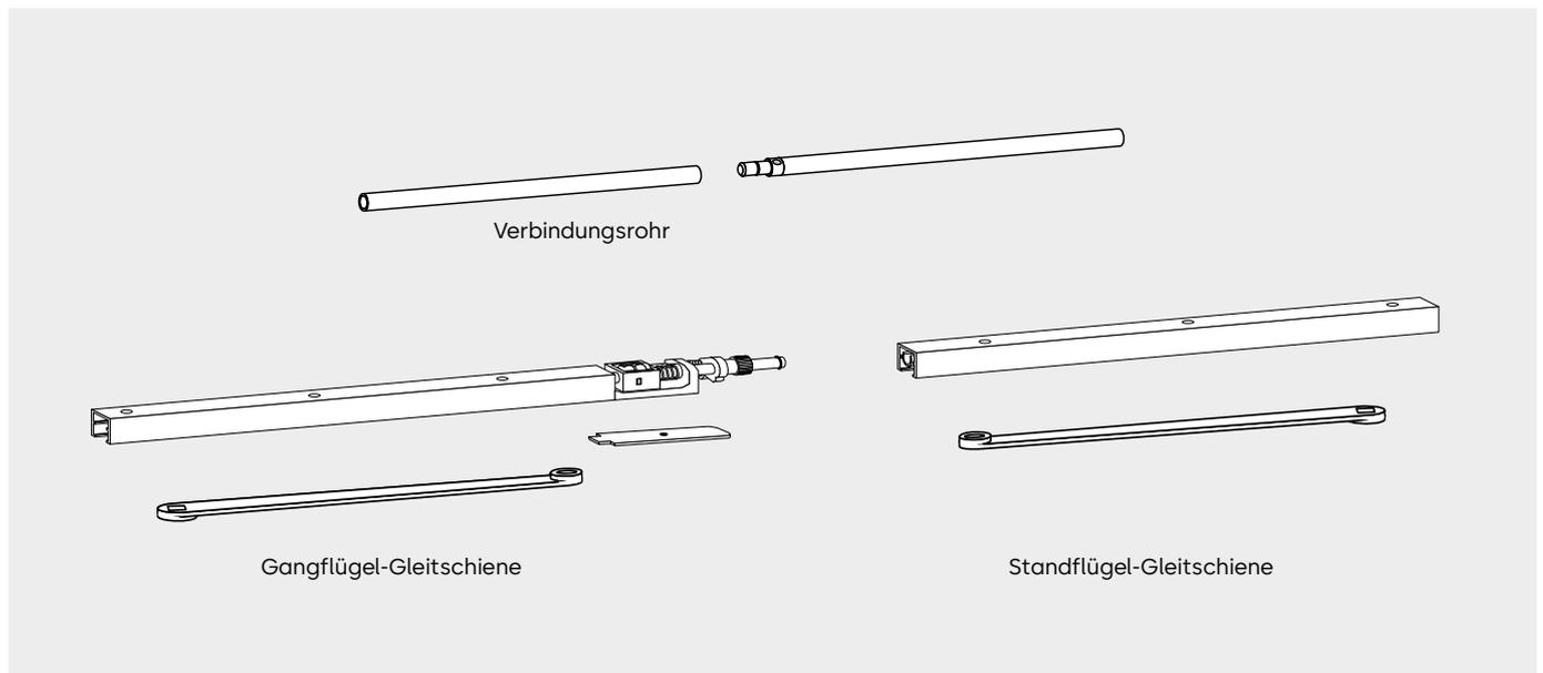
Ein Gleitschienen-Schließfolgeregler umfasst eine Gang- und Standflügel-Gleitschiene mit Öffnungsbegrenzung, ein Verbindungsrohr, eine Abdeckung für den Lagerbock der Gangflügel-Gleitschiene und zwei Hebel.
