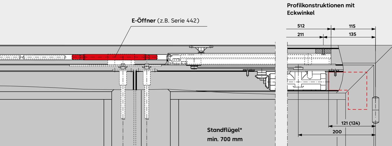
**F** Bei der Montage in Feuer- und Rauchschutztüren ist die Mitnehmerklappe MK 397 zu verwenden.
