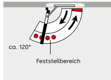
Die Rastfeststelleinheit **RF** ermöglicht ein exaktes Feststellen von Türen ohne Rückfederung bis zu einem Öffnungswinkel von ca. 120°. Die Ausrückkraft kann der jeweiligen Türsituation angepasst werden. Die RF-Einheit ist sowohl für DIN-L- als
