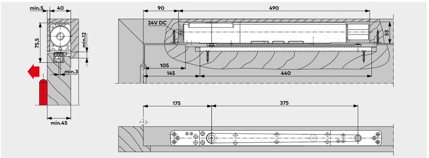
Türschließer ITS 96 FL mit Gleitschiene G 96 N20 in einer Holz
