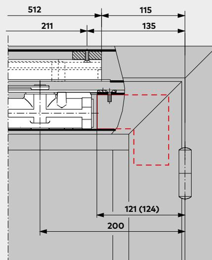
**F** Bei der Montage in Feuer- und Rauchschutztüren ist die Mitnehmerklappe MK 397 zu verwenden.
