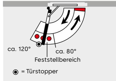
Die Gleitschiene ermöglicht ein exaktes Feststellen der Tür ohne Rückfederung. Der Feststellpunkt ist auf einen Öffnungswinkel zwischen ca. 80° und 120° einstellbar.
