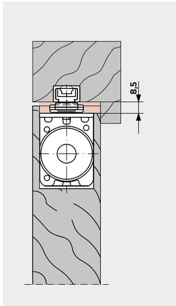
Holz­tür mit Stahl­zarge, stumpf an­schlagend, Falz­raum 12,5 mm, mit ITS 96/ITS 96 FL EN 3–6 mit 4 mm ver­längerter Achse und Gleit­schiene G 96 N20 K8.
