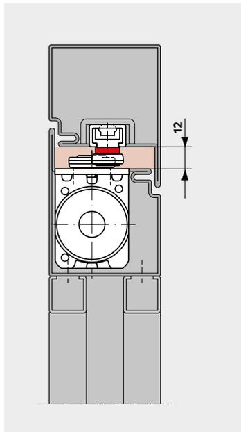
Alu­minium-Rohr­rahmentür, flächen­bündig an­schlagend, Falz­raum 16 mm, mit ITS 96/ITS 96 FL EN 3–6 mit 4 mm ver­längerter Achse und Gleit­schiene G 96 N20 K12.
