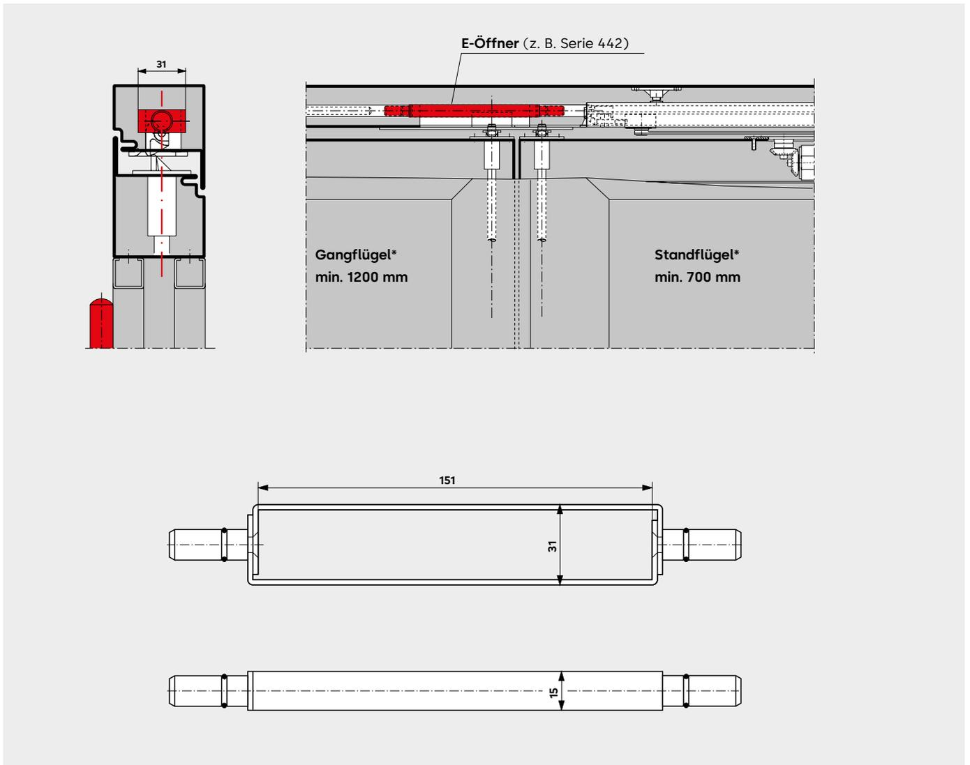
Verbindungsrahmen für **G 96 GSR** für die Verwendung an Türen mit E-Öffner bzw. oberer Türverriegelung.
