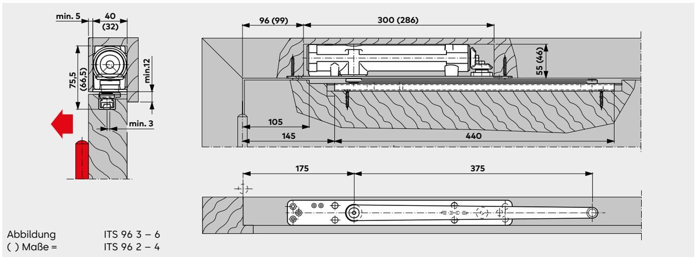
Türschließer ITS 96 mit Gleitschiene G 96 N20 in einer Holztür in **Kopfmontage**
