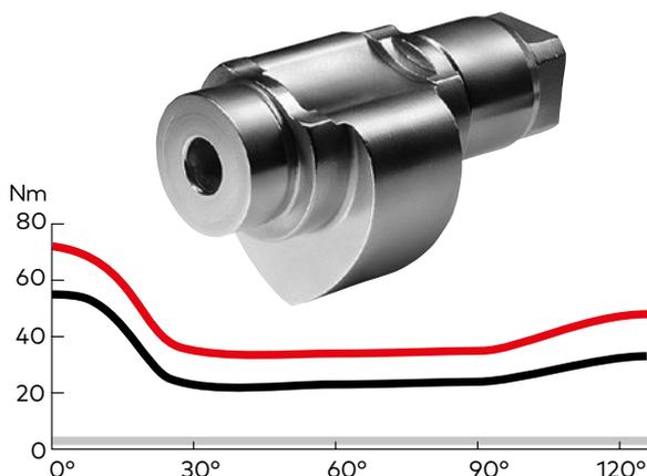
Momentenverlauf eines Gleitschiene-Türschließers ITS 96 (Größe EN 3 – 6, max. Schließkrafteinstellung)
