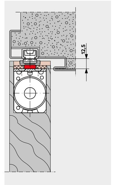
Stahl-Rohr­rahmentür, flächen­bündig an­schlagend, Falz­raum 12 mm, mit ITS 96/ITS 96 FL EN 3–6 und Gleit­schiene G 96 N20 K12.
