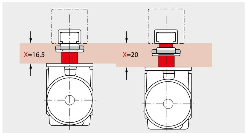
Holz­tür, stumpf an­schlagend, Falz­raum 8,5 mm, mit ITS 96/ITS 96 FL EN 3–6 und Gleit­schiene G 96 N20 K8.
