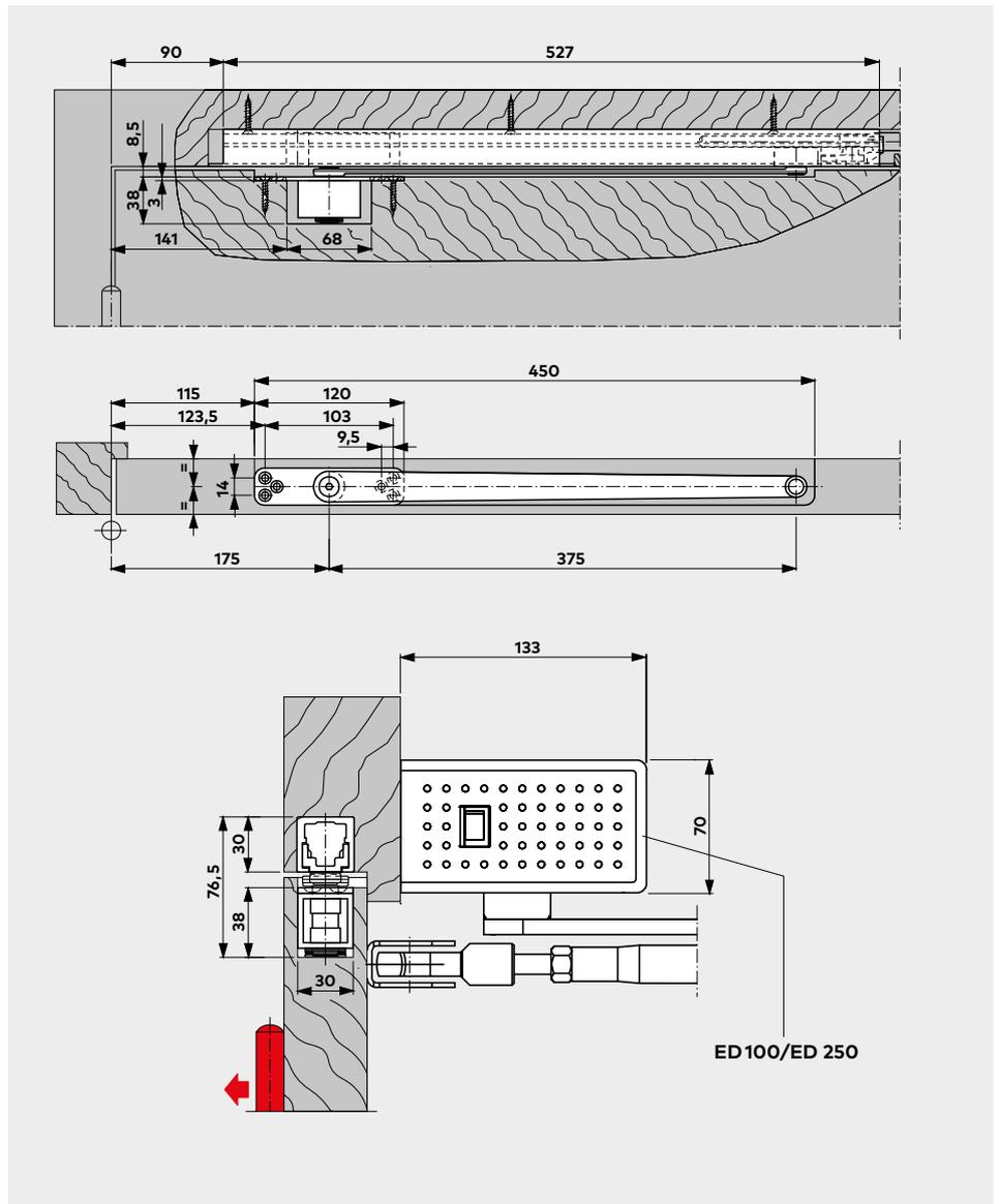
Das Drehlager kann in Verbindung mit der Gleitschiene G 96 N20 auch als **Öffnungsbegrenzung** eingesetzt werden.
