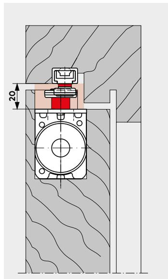
Stahl­blechtür mit Stahl­zarge, über­fälzt, Falz­raum 12 mm, mit ITS 96 EN 3–6 mit 4 mm ver­längerter Achse und Gleit­schiene G 96 EMF K8.
