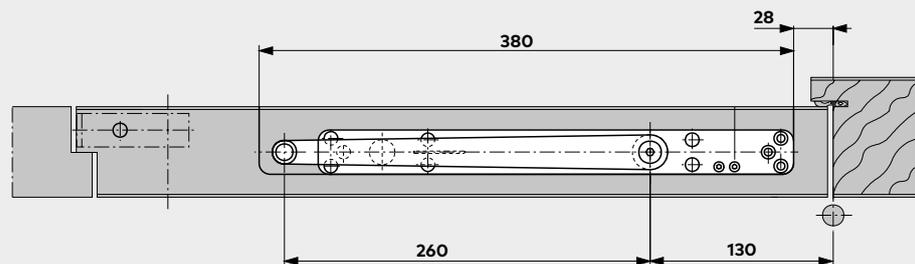
**F** Bei der Montage in Feuer- und Rauchschutztüren ist die Mitnehmerklappe MK 397 zu verwenden.
