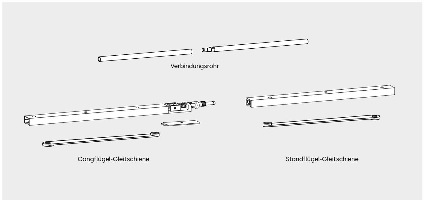
Ein Gleitschienen-Schließfolgeregler 96 GSR umfasst eine Gang- und Standflügel-Gleitschiene mit Öffnungsbegrenzung, ein Verbindungsrohr, eine Abdeckung für den Lagerbock der Gangflügel-Gleitschiene und zwei Hebel.
