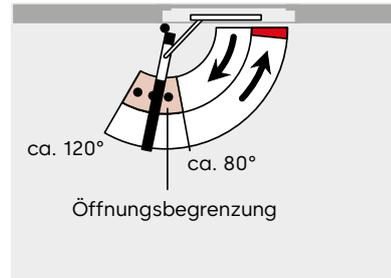
Die Gleitschiene umfasst Hebel, Gleit-schiene, Gleitstück, Öffnungs-begrenz-ung und Befestigungs-schrauben und kann mit beiden Türschließergrößen des ITS 96 kombiniert werden.
