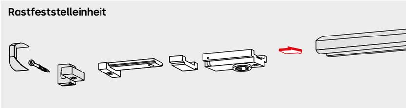
Die Rastfeststelleinheit ermöglicht ein exaktes Feststellen von Türen ohne Rückfederung bis zu einem Öffnungswinkel von ca. 145°.
