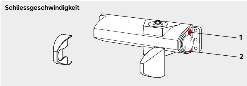
Die Schliessgeschwindigkeit des TS 90 Impulse ist über Ventile in zwei voneinander unabhängigen Bereichen stufenlos einstellbar.
