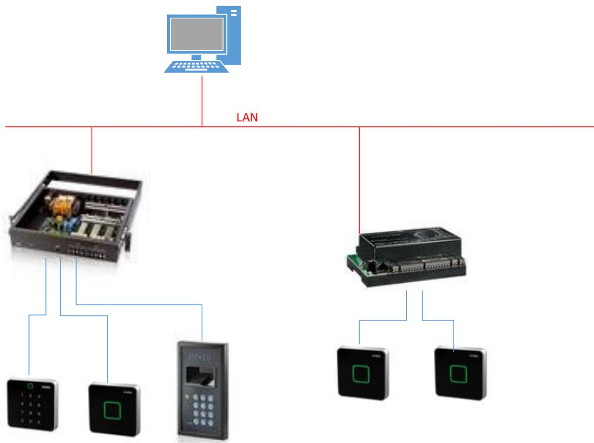
Alle Systeme sind über Netzwerk ansprechbar. Dadurch sind auch Kopplungen über VPN mit entfernten Standorten möglich. Je nach eingesetzter Hardware sind auch weitere Funktionen wie etwa Türüberwachung, Schleusen- und Ablaufsteuerungen abbildbar.
