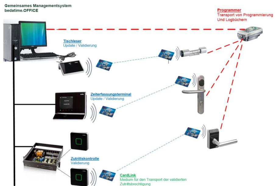
Für bedatime®.CARDLINK Systeme wird nur ein persönliches Medium benötigt. Dasselbe Medium kann auch für weitere Anwendungen, wie Zeiterfassung, Biometrie, elektronische Geldbörse etc., verwendet werden. Die Schreib- und Leseperformance liegt unter einer Sekunde. Mit Hilfe des CardLink™-Validierungs-mechanismus werden verlorene oder nicht autorisierte Medien nicht nur im Onlinesystem umgehend gesperrt, sondern mit nur minimalem Verzug auch in den Standalone-Komponenten.
